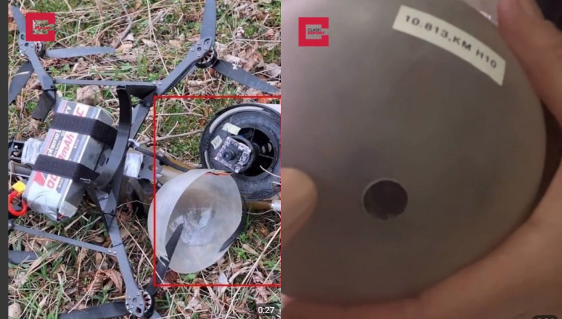
FPV- дрон с оптоволоконной катушкой управления (отмечена красным контуром), длина такого кабеля может достигать 10 км
